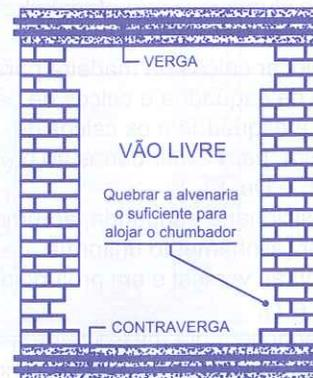
3- Deixar o vão livre com folga mínima de 2 centímetros na largura e 3 centímetros na altura, tendo como base as dimensões da esquadria.
